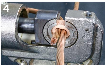
4 Execute a compressão do conector pressionando o avanço da ferramenta. Após completar todo o percurso, o cabeçote retornará automaticamente.
