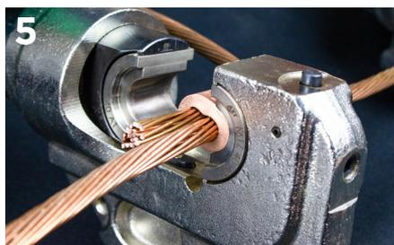
5 Remova a ferramenta da instalação e verifique se a compressão foi realizada corretamente.
