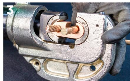
3 Ajuste a ferramenta para iniciar a compressão. Recomendamos utilizar ferramentas hidráulicas como HCT120B, HCT120E ou HCT120M, junto com a matriz MTZ 997 AT, disponíveis na AXT.
