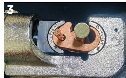
3 Ajuste a ferramenta para iniciar a compressão. Recomendamos utilizar ferramentas hidráulicas como HCT120B, HCT120E ou HCT120M, junto com a matriz MTZ 998 AT, disponíveis na AXT.
