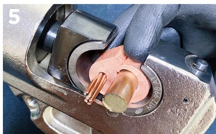
5 Remova a ferramenta da instalação e verifique se a compressão foi realizada corretamente, não havendo grandes espaços entre o conector e os condutores.
